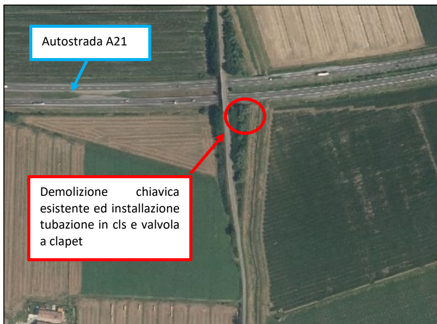
Figura 10 – Canale Scovalasino: rifacimento paratia esistente ed installazione di nuova tubazione in CLS DN1000 e valvola di non ritorno.
