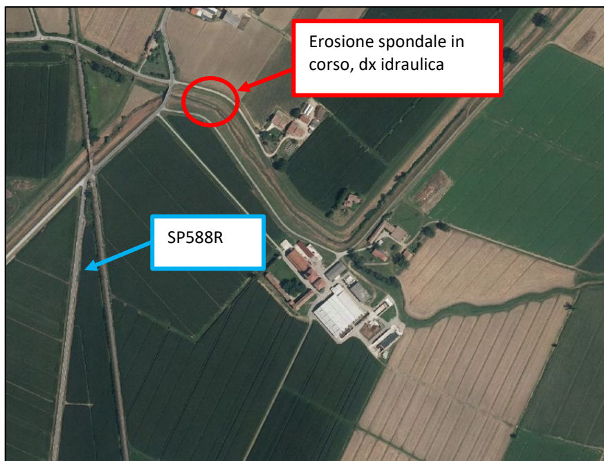
Figura 15 – Colatore Fontana: inquadramento planimetrico dell'erosione spondale in corso.
